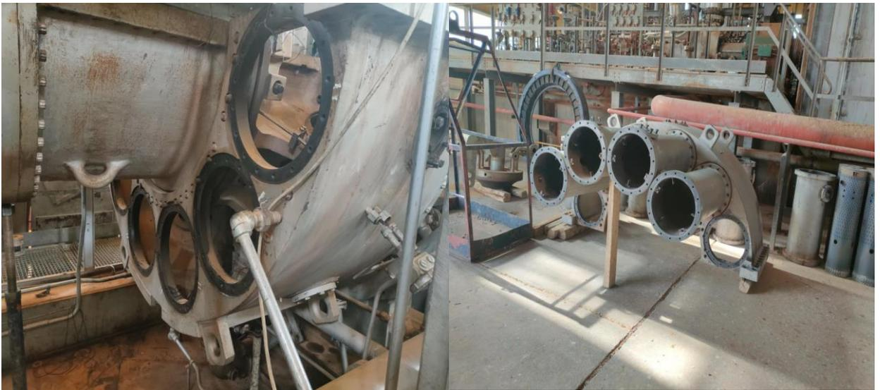
**Figure II.9 : Chambre de combustion**
