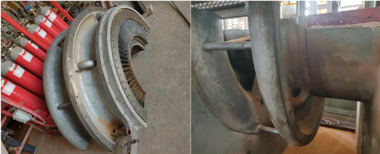
Figure II.4 : Admission de la turbine à gaz
