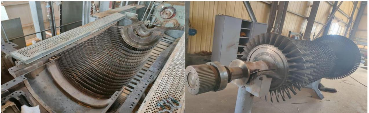
**Figure II.7 : Compresseur axial rotor et stator**
