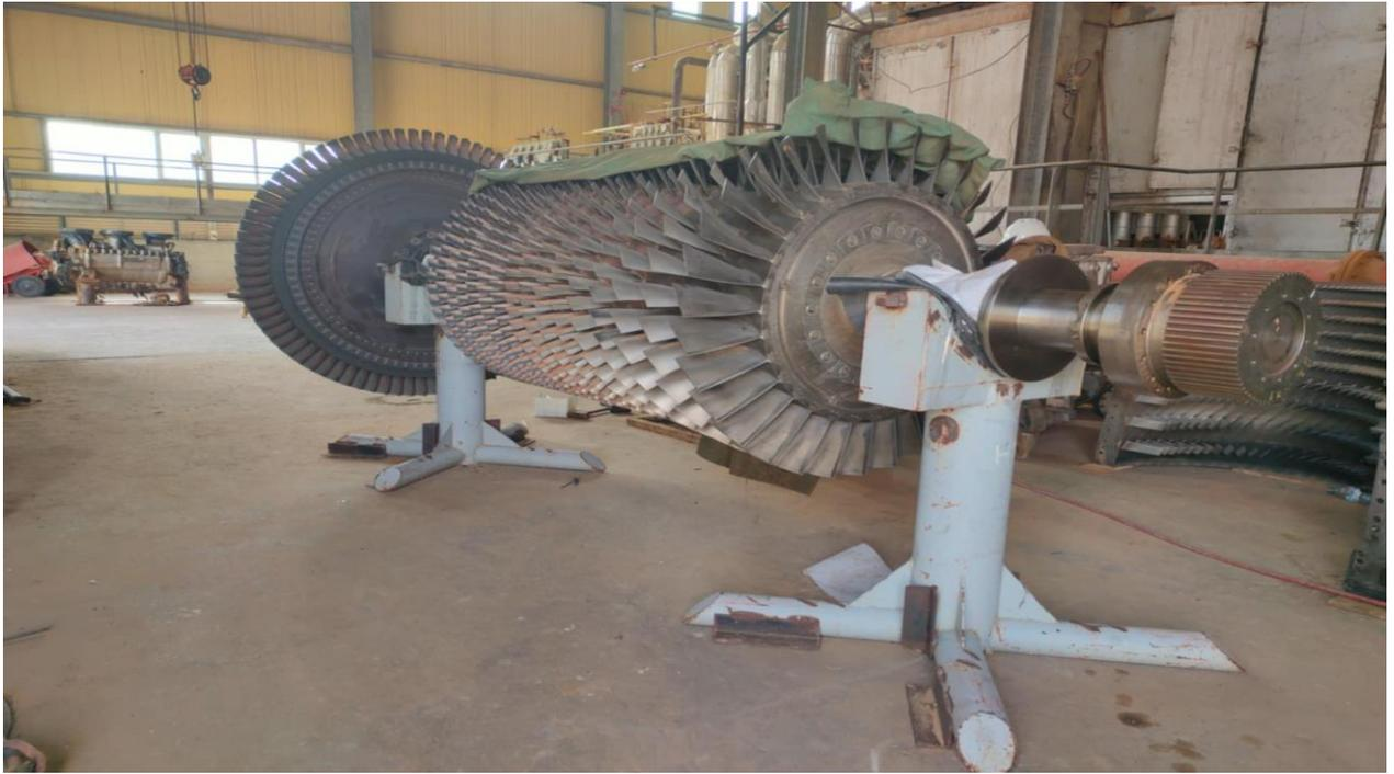
**Figure II.8 : Corps de compresseur axial de la TAG MS5002C**
