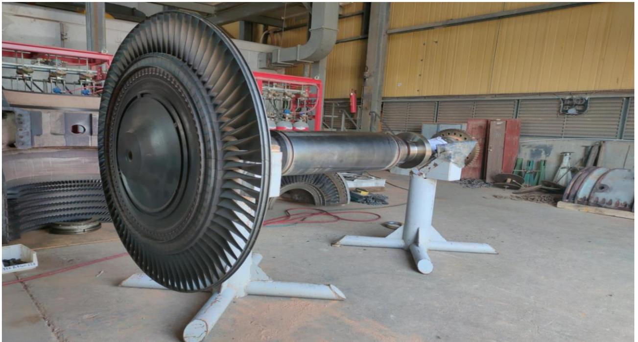
Figure II.14 : roue BP de deuxième étage
