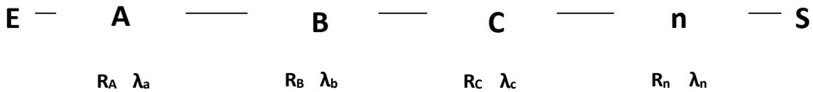
Figure III.8 : Diagramme de fiabilité d'un système constitué de N éléments en série
