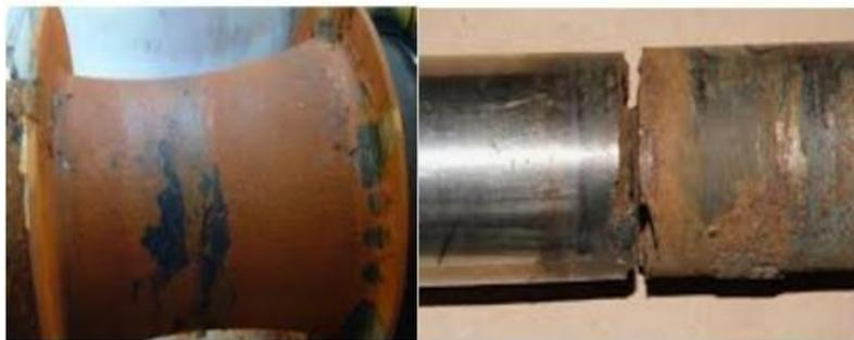
Figure 1-6 : Photos de la fatigue-corrosion
