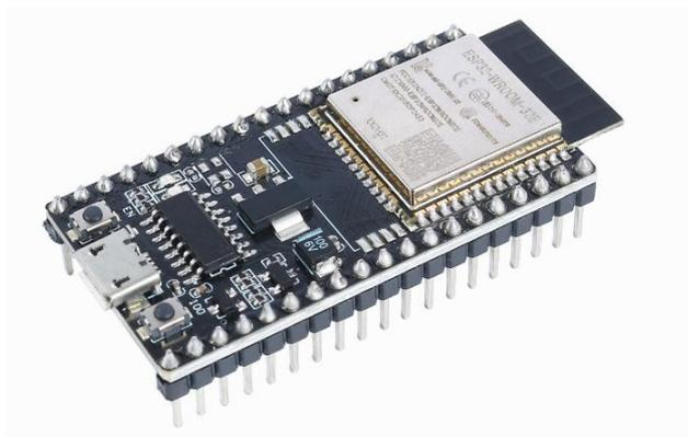
**Figure 4-2:** Un microcontrôleur ESP32
