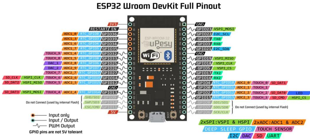
Figure 6-1: ESP32 – Vue des ports et connexions
