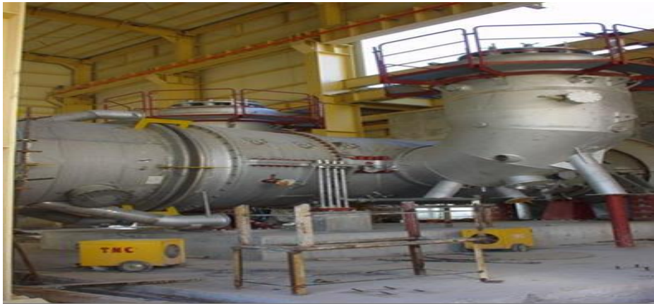
Figure 2.16 : Chambre de combustion [20].
