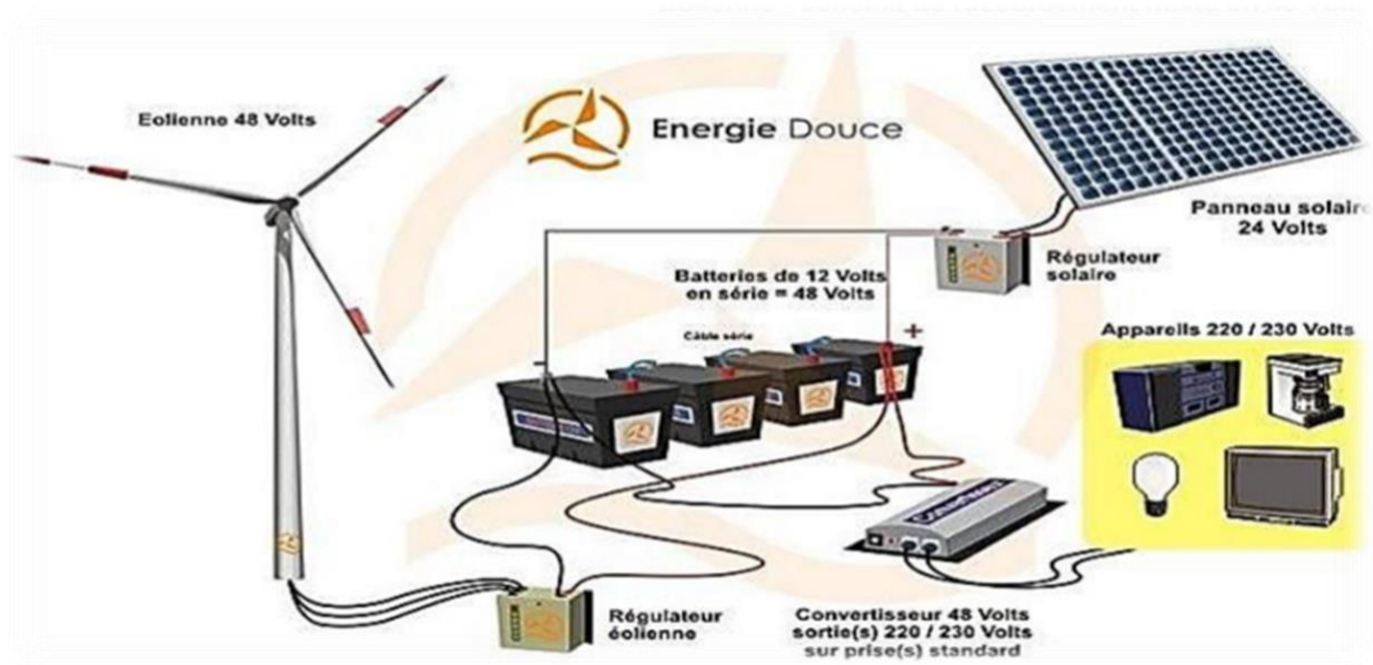
Figure3.7 : Systèmes d'alimentation autonome hybride Photovoltaïque
