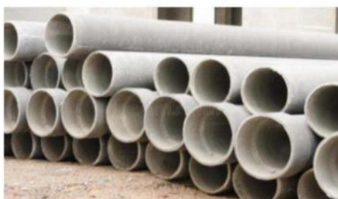
Figure I.12: Tuyaux en amiante-ciment (ENGEES)
