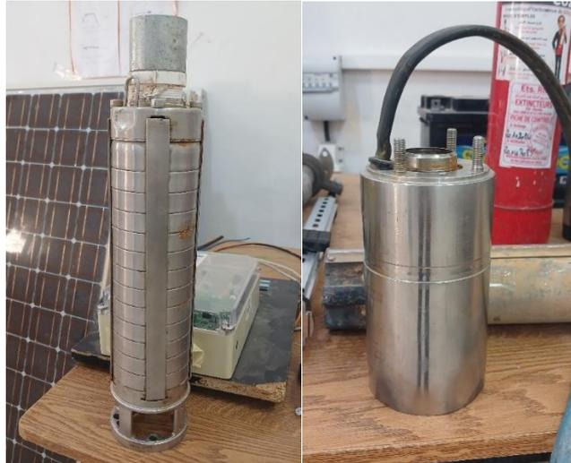
Figure 3-8: Pomme centrifuge et Moteur à courant continu sans balais
