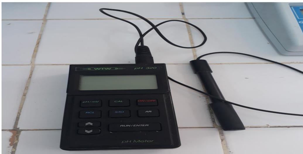
**Photo 01** : Le pH mètre (Type WTW model pH 320). (Originale 2018)
