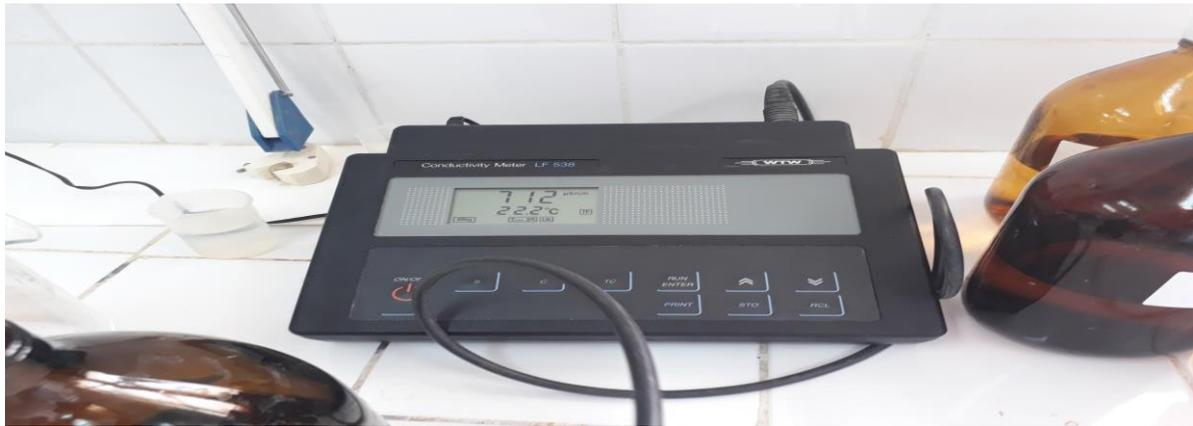
**Photo 02:** Conductimètre. (Type WTW modèle LF 538). (Originale, 2018)
