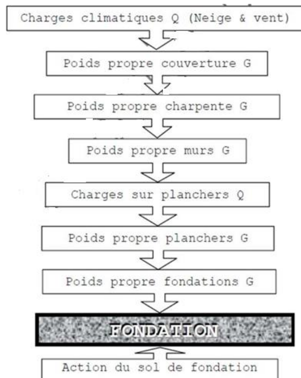
Figure 1.1: la structure porteuse transmet toutes ces charges au sol par l'intermédiaire des fondations (1)
