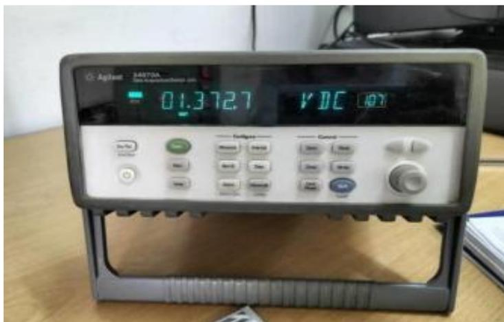
**Figure III.11:** Enregistreur de données Agilent, modèle 34970A.
