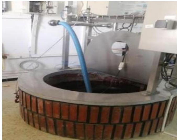
**Figure III. 8 :** Banc d'essai du système de pompage photovoltaïque.
