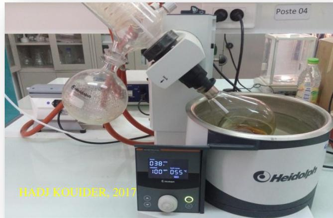
**Photo 06-** Dispositif d'évaporation de Méthanol.
