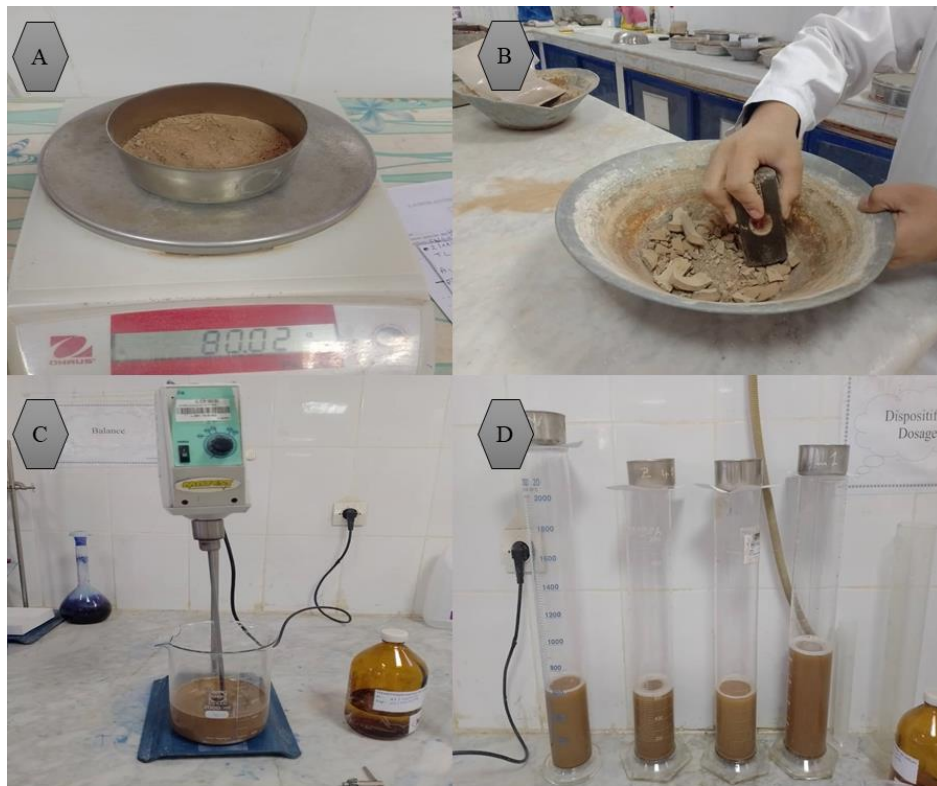
(A),(B) pesé 80g de l'échantillon et le broyé.(C) Mettre dans un verre l'eau distillée et produit Hexèmtaphosphat de sodium et mélanger pendant 3min. , (D) puis laisser reposer pendant au moins 15h.
