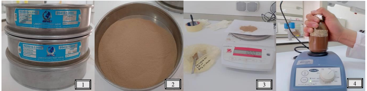
(1) les tamis de 160 µm et 80 µm, (2) le sol d'échantillon tamisé, (3) pesés 10g de chaque échantillon de sol, (4) une suspension agitée pour libérer la charge microbienne.
