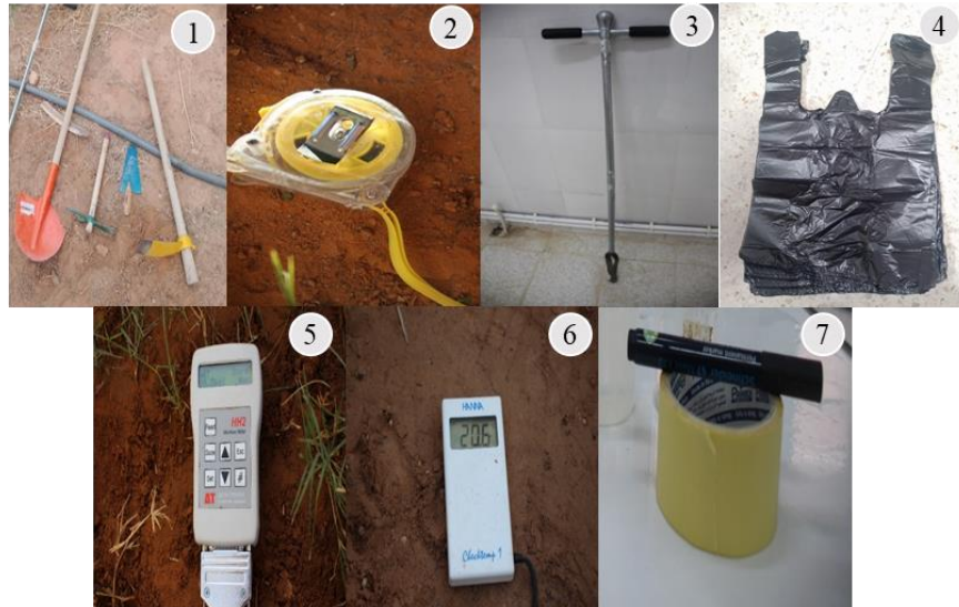
(1) Matériel de creusage,(2) Décimètre, (3) Tarière pédologique,(4) Sachets en plastique,(5) Marqueur et des étiquettes, (6) Thermomètre du sol, (7) Hygromètre du sol.
