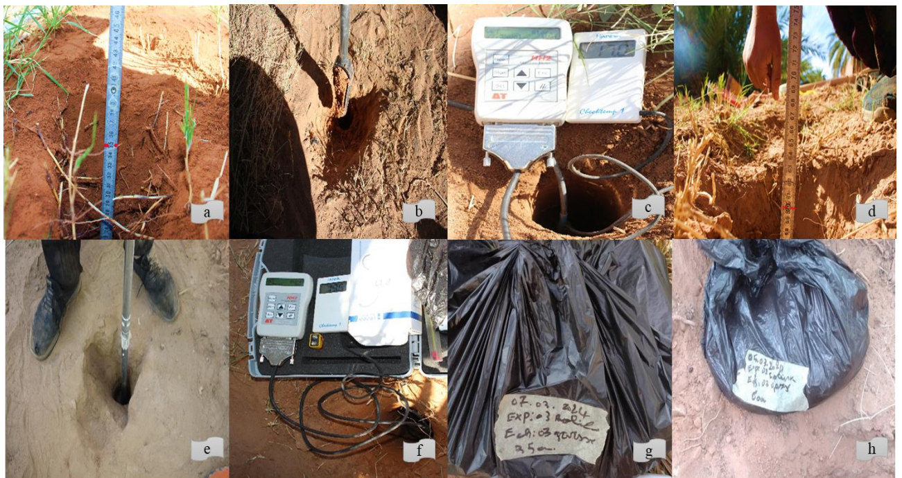
(a) La profondeur du trou est de 35 cm, (b) prélève le sol de profondeur 35 cm par tarière, (c) mesuré la température et l'humidité de sole par thermomètre de sol et Hygromètre de profondeur 35 cm , (d) La profondeur du trou est de 60 cm, (e) prélève le sol de profondeur 60 cm par tarière, (f) mesuré la température et l'humidité de sole par thermomètre de sol et Hygromètre, (g) l' échantillon de profondeur de 35 cm dans sachet plastique, (h) l' échantillon de profondeur de 60 cm dans sachet plastique.
