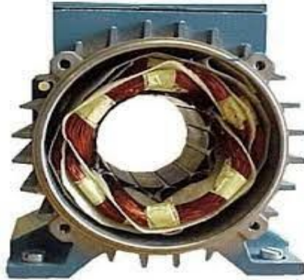
Fig.I.1. Le stator de la machine asynchrone
