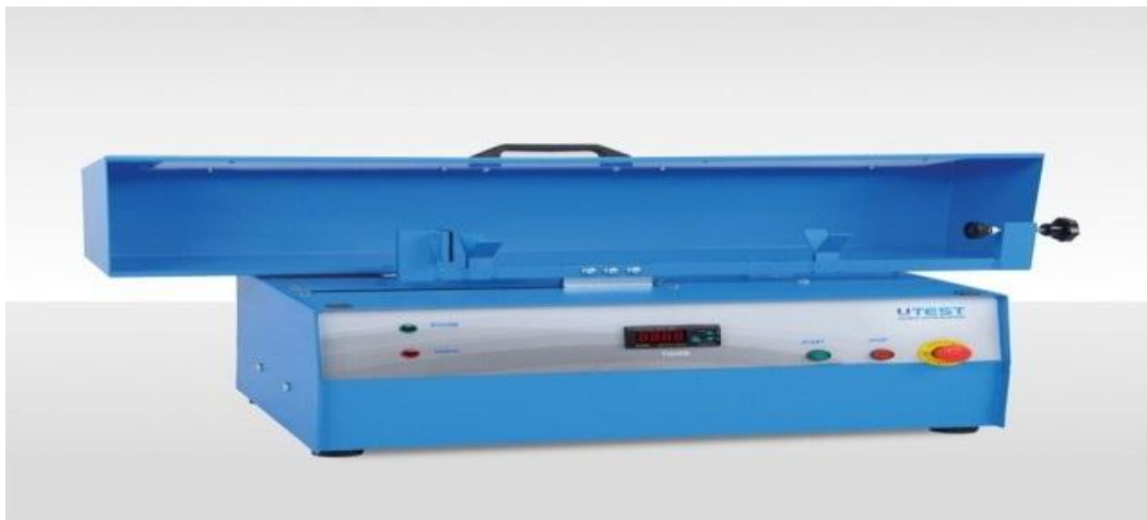
Photo III-4:Machine d'agitation pour Équivalent de sable
