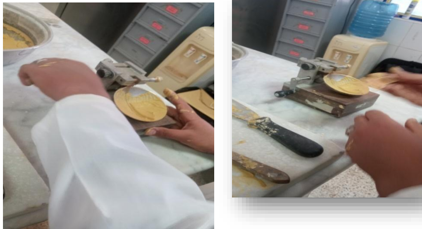
Photo III-6:Détermination de la limite de liquidité.
