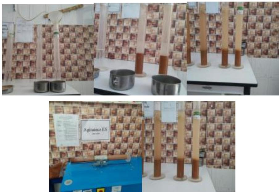
**Figure II.7. L'essai del'équivalent du sable.**
