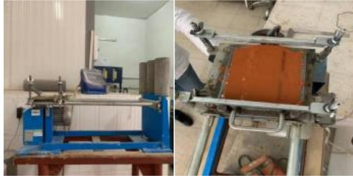
Figure II.17. Le moule est rempli et installé sur la table d'impact.
