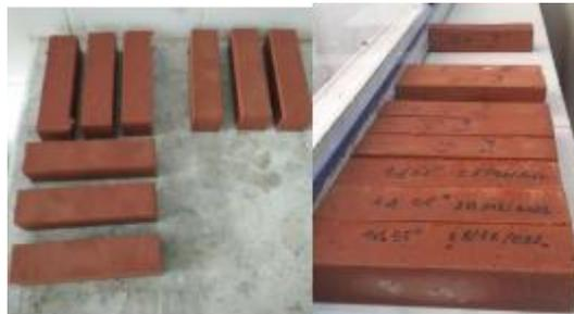
Figure II.17. Démoulage les échantillons.
