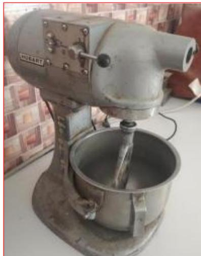
**Figure II.15. Malaxeur électrique utilisée dans la fabrication du mortier [service de Béton -LTPS].**
