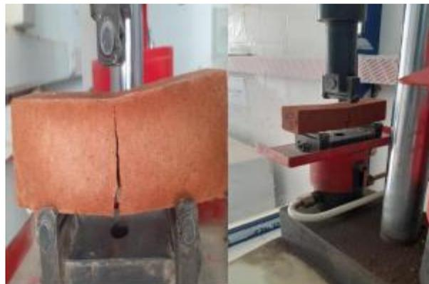
Figure II.19. Dispositif de l'essai mécanique de rupture par flexion.
