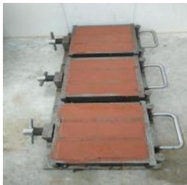
**Figure II.14. Moule normalisé de 40x40x160 mm à LTPS.**
