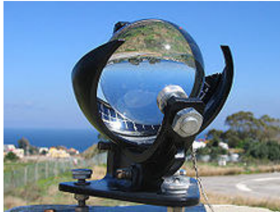
Fig II.20: Héliographe pour la mesure de l'insolation.
