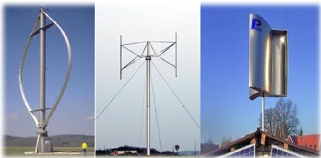
Figure I.2 : Les éoliennes à axe vertical.
