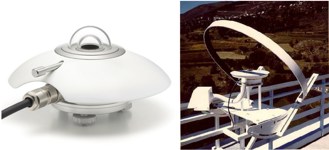
Fig II.19: Pyranomètre pour la mesure du rayonnement global et diffus.
