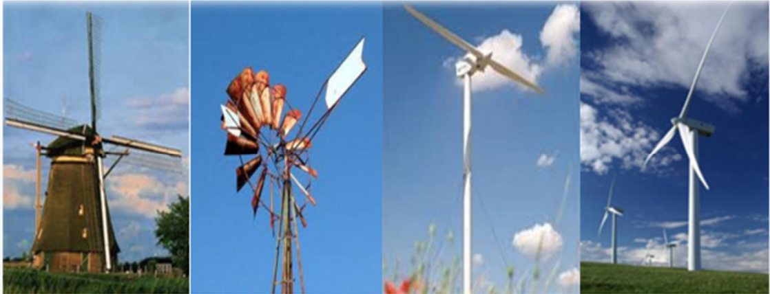
Figure I.3 : Les éoliennes à axe horizontal.
