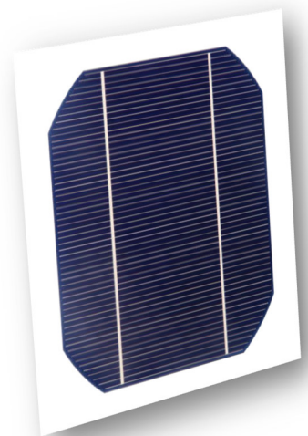
Figure I.7 : Cellules en silicium monocristallin.
