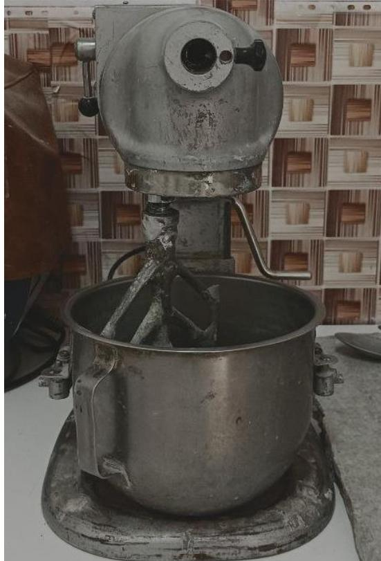
**Figure III.6 :** Malaxeur normalisé pour pâte utilisé
