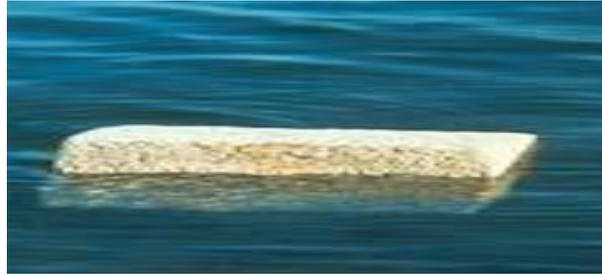
**Figure I.8** : légèreté du béton cellulaire[13]
