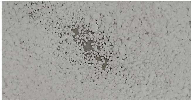
**Figure (III.4) :** Billes de polystyrène
