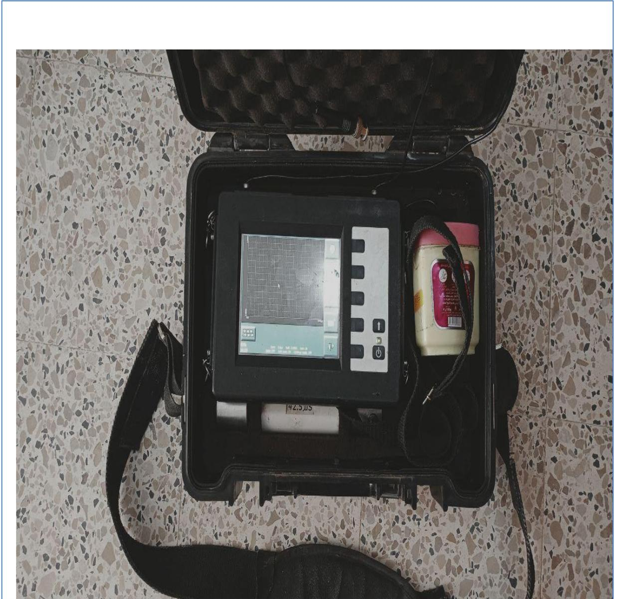
**Figure III.31 :** Appareil utilisé pour mesurer la vitesse du son dans le béton
