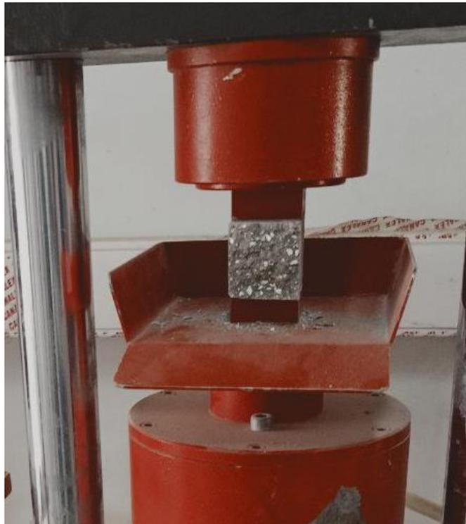
**Figure III.29 :** Un appareil pour mesurer la compression de l'échantillon.
