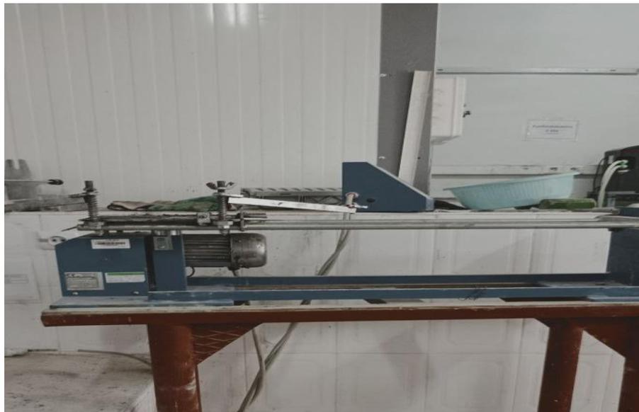
**Figure III.8 :** appareil à choc de mortier
