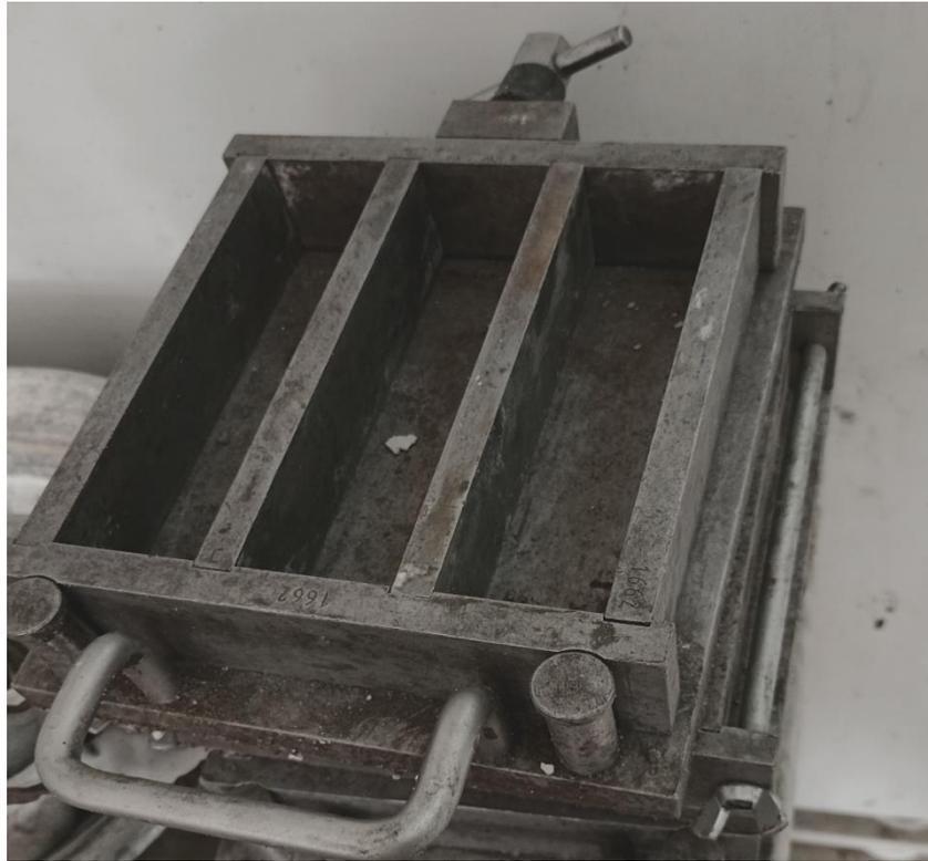
**Figure (III.7) :** Moules utilisés
