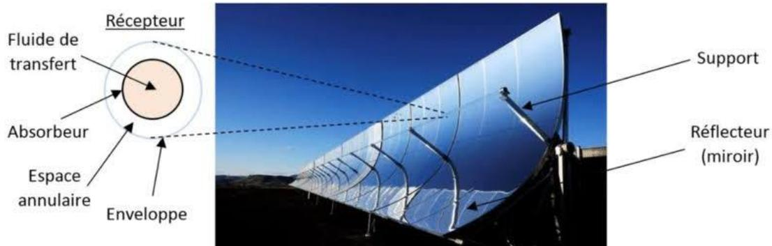
Figure (I.4): cylindre-parabolique.
