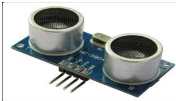
Figure II.12: Capteur ultrason Module HC-SH04 [34]
