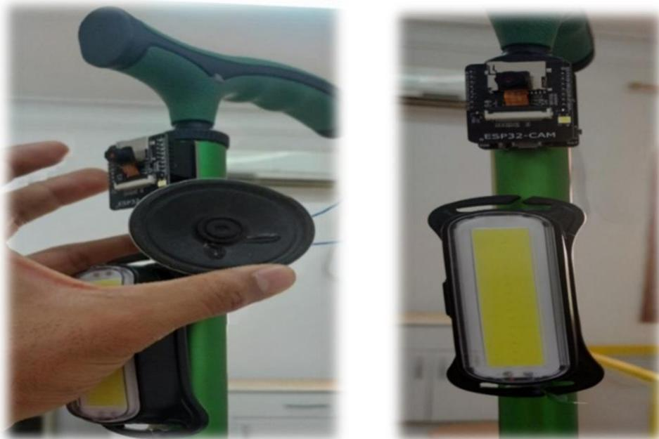
Figure III.21: Installation ESP32-CAM et Haut-Parleur
