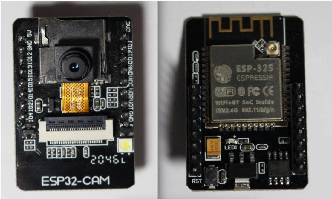
Figure II.15: MODULE ESP32-CAM ET CAMERA OV2640[5]
