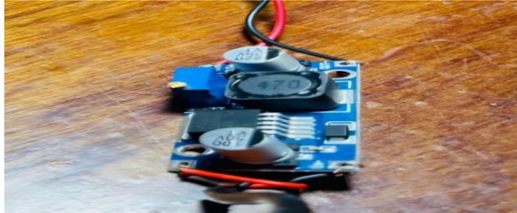
Figure III.8: convertisseur d'énergie LM2596
