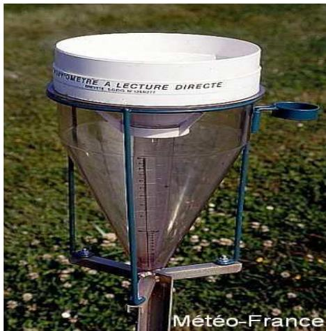
**Figure (08) :** Pluviomètre à lecture direct
