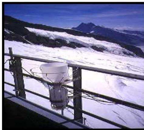
**Figure (13) :** mesure de l'équivalent en eau des chutes de neige
