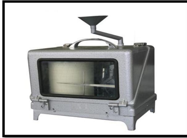
**Figure (12) :** Pluviographe transducteur d'impulsions
