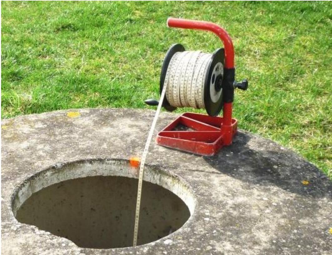
**Figure N°27 - La sonde piézométrique**
