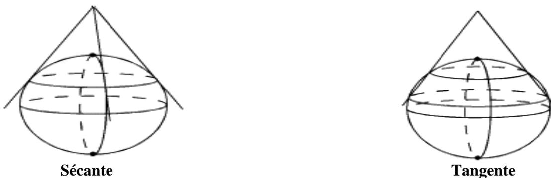
**Figure N°01 - Les projections coniques**
