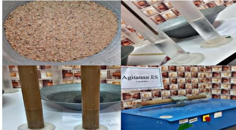
Photo II.7. Essai équivalent de sable. (Source : Auteurs)
