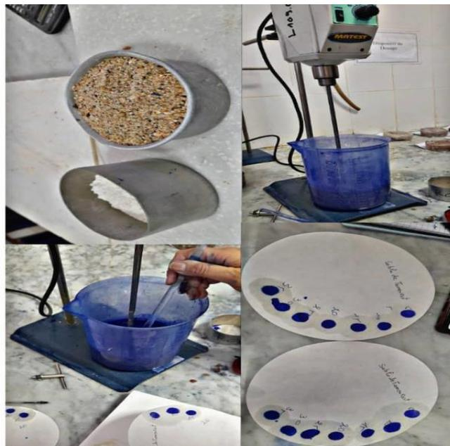
Photo II.8. Essai au bleu de méthylène. (Source : Auteurs)
