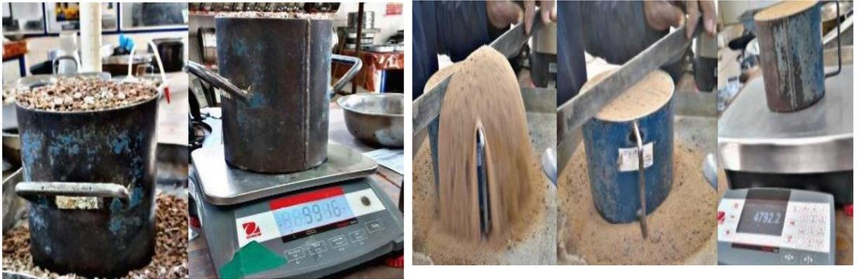
Photo II.5. Masse volumique apparente des granulats. (Source : Auteurs)
