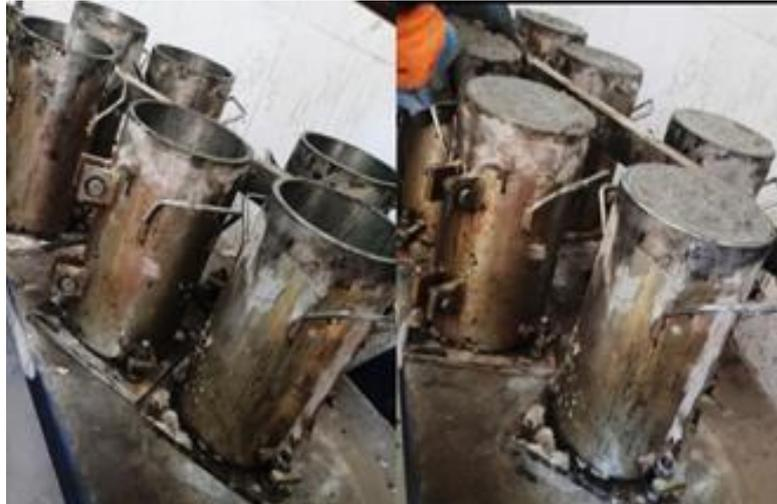
Figure II.20. Éprouvettes de béton 15x30.
