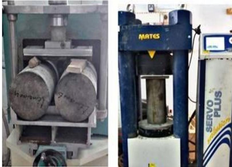
**Photo II.22.** Mesure de la résistance à la compression du béton. (Source : Auteurs)
