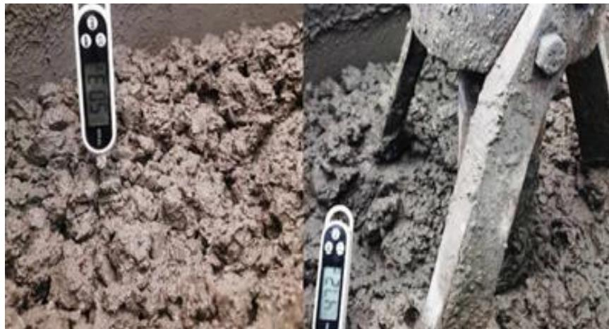
**Figure II.19.** Mesure de la température du béton frais. (Source : Auteurs)
