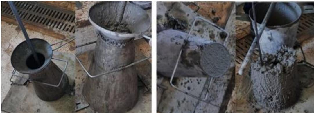
Photo II.21. Mesure de l'affaissement au cône d'Abrams. (Source : Auteurs)
