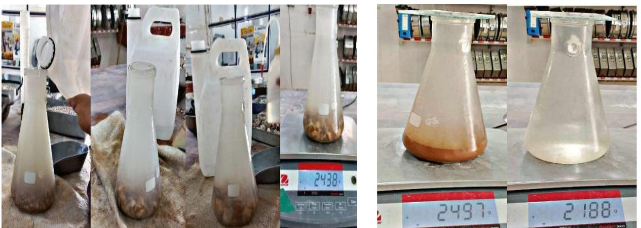
Photo II.6. Masse volumique absolue des granulats. (Source : Auteurs)
