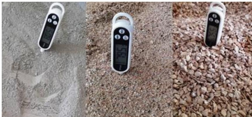
**Photo II.17.** Mesure des températures des matériaux avant le malaxage. (Source : Auteurs)
