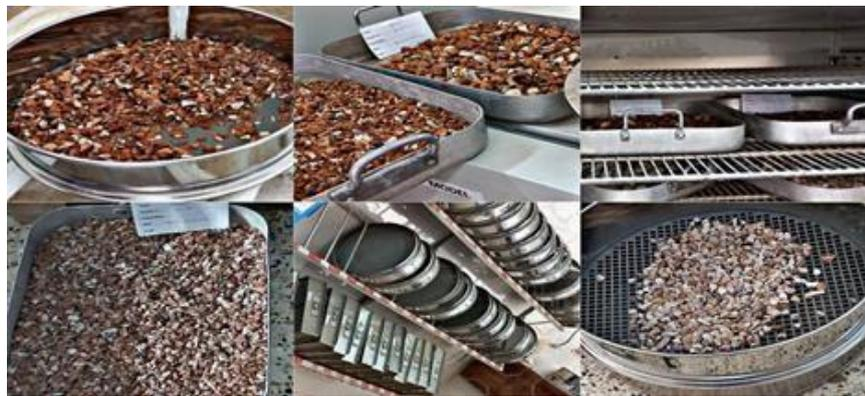
Photo II.4. Analyse granulométrique de gravier. (Source : Auteurs)
