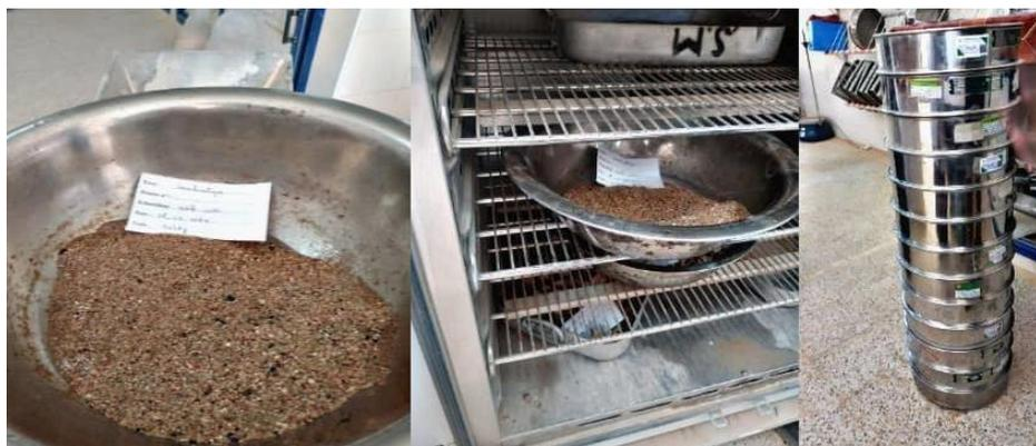
**Photo II.3.** Analyse granulométrique de sable. (Source : Auteurs)
