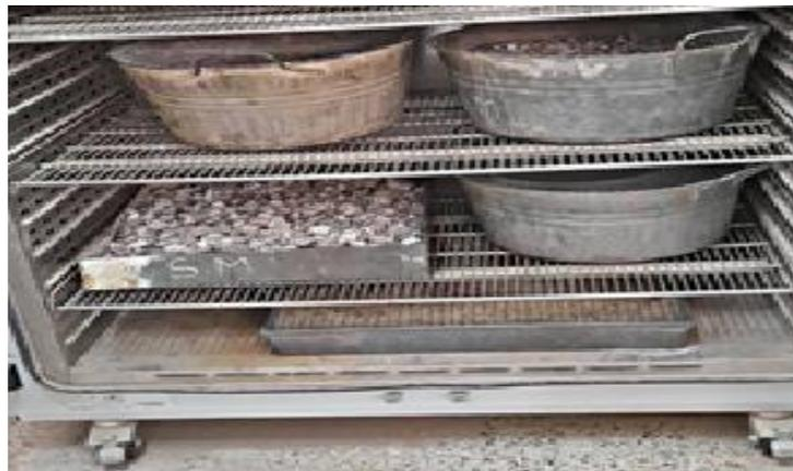
Photo II.16. Préchauffage des granulats et du ciment dans l'étuve. (Source : Auteurs)
