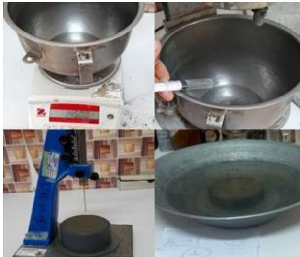
**Figure II.13.** Essai de prise de ciment.
