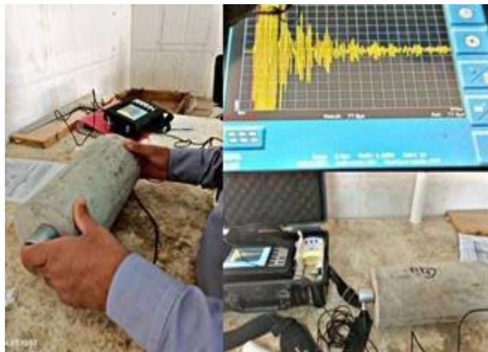
**Figure II.23.** Mesure de la vitesse de son dans le béton. (Source : Auteurs)
