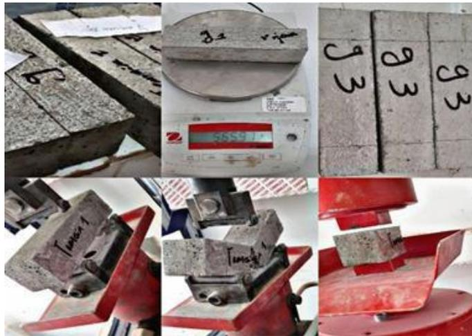
**Photo II.15.** Mesure de la résistance mécanique du mortier. (Source : Auteurs)
