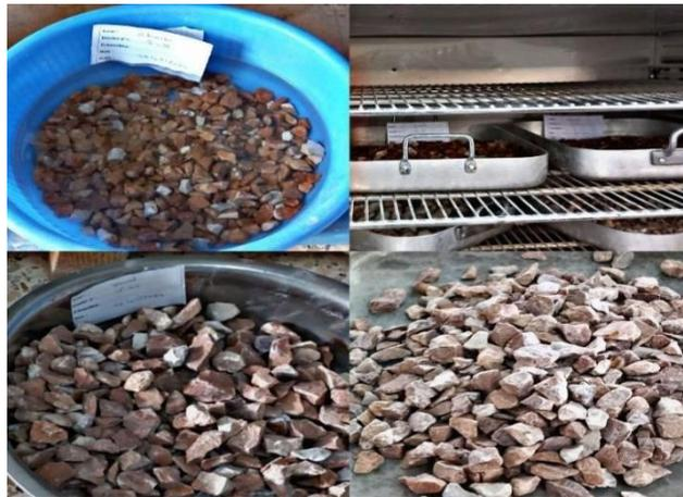
**Photo II.11.** Essai d'absorption d'eau. (Source : Auteurs)
