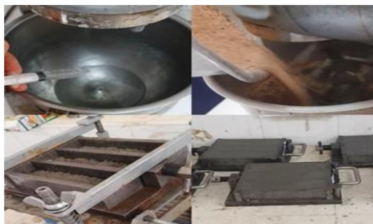
**Photo II.14.** Confection des éprouvettes de mortier. (Source : Auteurs)
