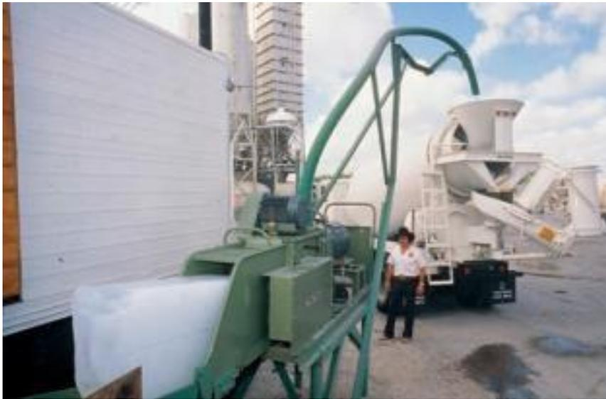
**Figure I.3.** Concasseur de glace pour le remplacement d'une partie d'eau lors de bétonnage par temps chaud. (Source : [11])
