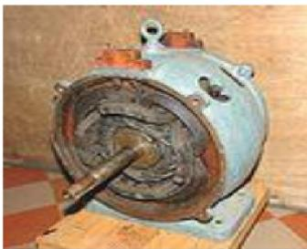
Intérieur d'une machine asynchrone diphasée, R. Alioth et Cie, no 1042, vers 1893
