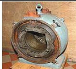
Le stator, 4 paires de pôles. Les deux borniers de raccordement.
