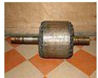
Le rotor, cage constituée de bobinages de cuivre en court-circuit. Les encoches sont légèrement inclinées.
