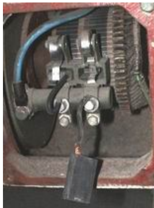
Figure 3.34 L'ensemble balais, porte-balais et collecteur.
