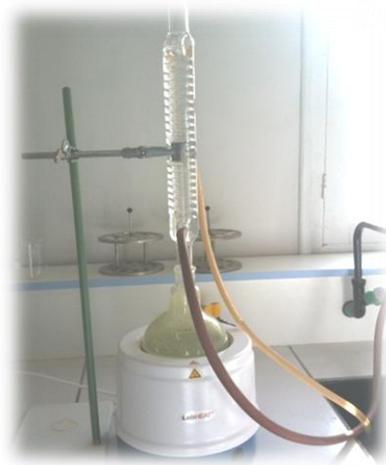
**Photo 6** -Dispositif d'extractions des principes actifs par reflux (originale).
