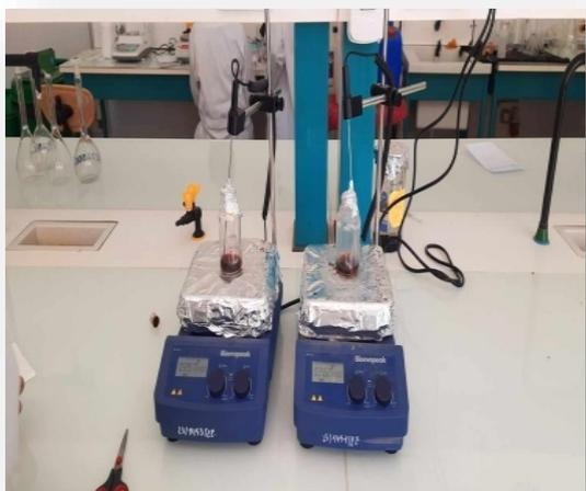
Figure IV-7 : Agitateur magnétique doté d'un Thermostat.
