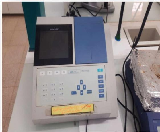
**Figure IV-3** : Spectrophotomètre- UV Visible modèle SECOMAM (Uvline 9400).
