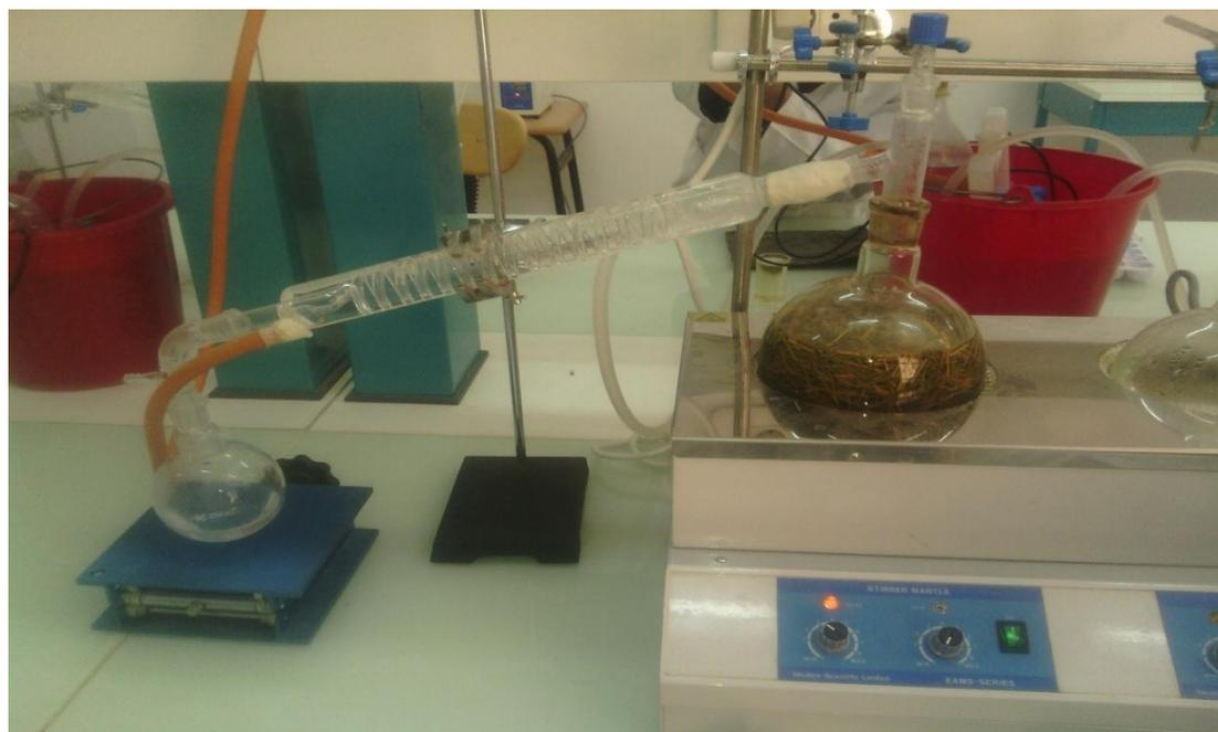
**Figure 8 :** Montage de l' hydrodistillation
