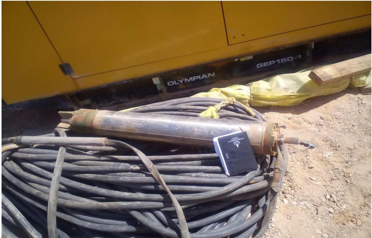
Pompe utilisé pour le développement du forage
