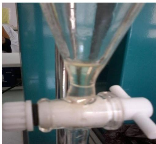
**Fig6: Huile +l'eau dans l'ampoule a décanté.**
