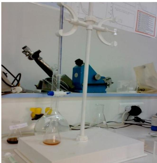
Fig8 : Dispositif de titrage pour définir l'indice d'acide.
