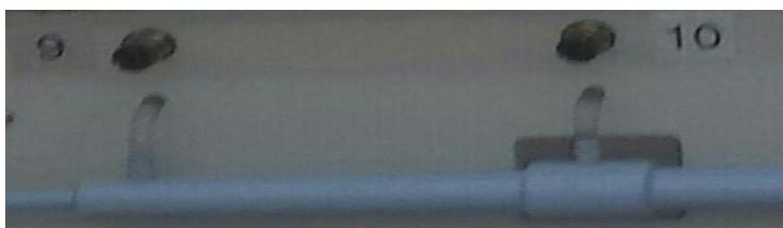
**Figure 20 : (9,10) soudaine élargissement (Ø13,6mm – Ø26,2mm)**
