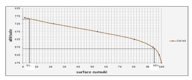
Fig. N° 19 - Courbes hypsométrique du bassin versant de l'Oued M'Zab (exutoire de l'Ateuf)
