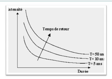
Fig. N° 05 - Représentation schématique des courbes IDF
