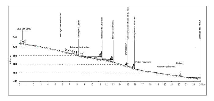
Fig. N° 10 - Coupe géomorphologique schématique de la vallée de M'Zab
