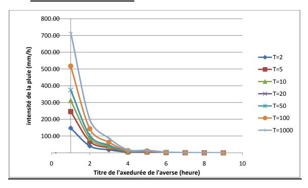
Fig. N° 24 - Courbe IDF « Intensité – Durée – Fréquence
