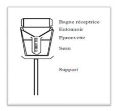
Fig. N° 01- pluviomètre
