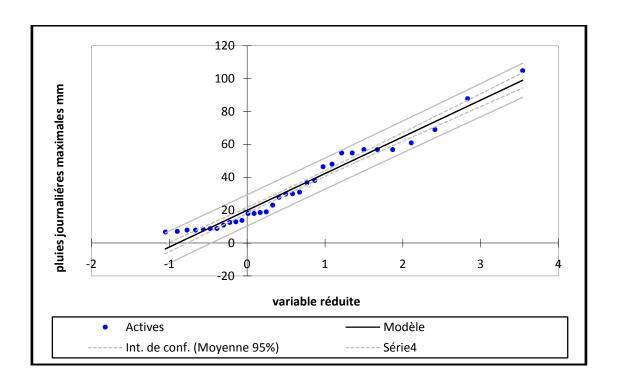
Fig. N° 22 - Ajustement graphique d'une loi de Gembel. (xlstat)
