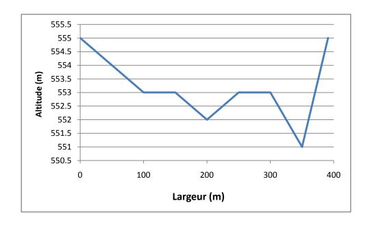
Fig. N° 34 - profile en traves d'oued Laadira
