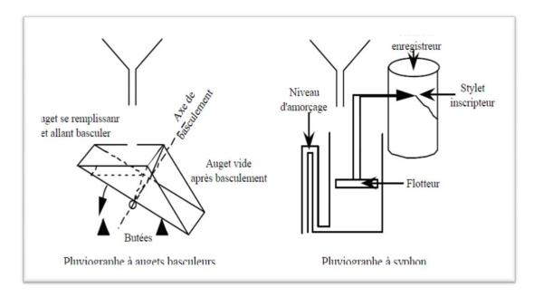
Fig. N° 02 - pluviographe a augets basculeurs et pluviographe a siphon
