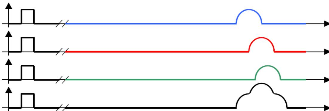
Figure II.4: Dispersion modale de la fibre optique multimode
