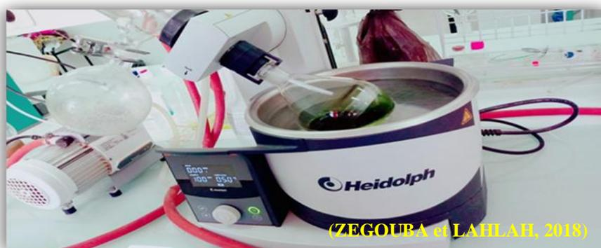
**Photo 10 :** Montage de rota vapeur pour l'élimination du solvant (Originale, 2018).
