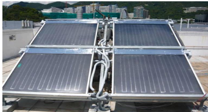
Figure 2.5 : Plateforme expérimentale du système hybride PV-SAHP/GHP. [39]
