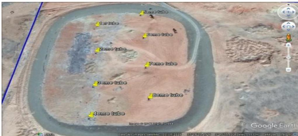
Figure N°13 : 8 sorties de biogaz installes dans le casier
