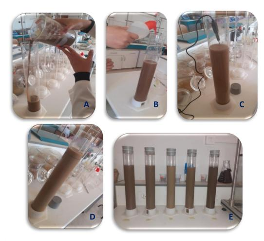
**Figure 14:** Etapes de mesure de la densité de liquide par le densimètre de Bouyoucos (Moulay Lakhder et Morsli, 2020).
