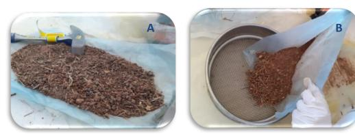
**Figure 11:** Préparation des échantillons aux analyses. **A** : Broyage, **B** : Tamisage (Moulay Lakhder et Morsli, 2020).
