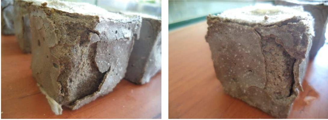
Fig.1 : Etat des mortiers après 12 mois d’immersion dans 5% MgSO<sub>4</sub> à 5 °C.
