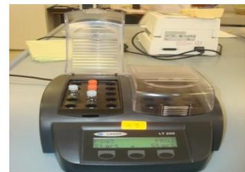
**Photos N° 07 :** Réactifs , Réacteur DCO et spectrophotomètre et Réactifs DCO
