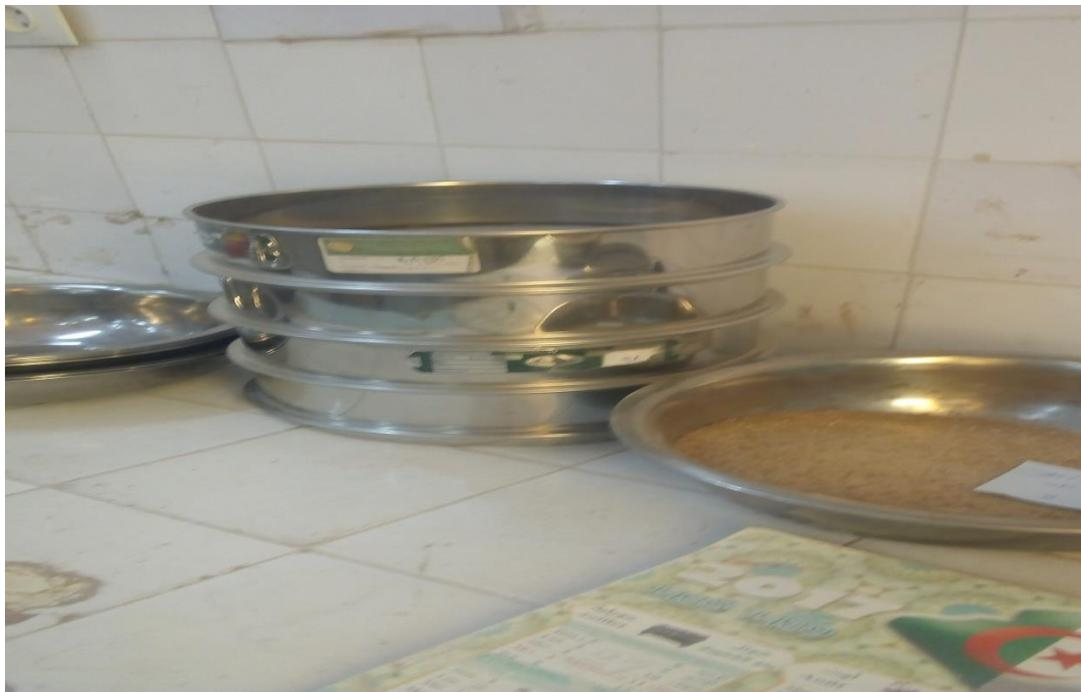
**Photos N° 12** : Présente la série des tamis et échantillon de sable Hassi Sayah
