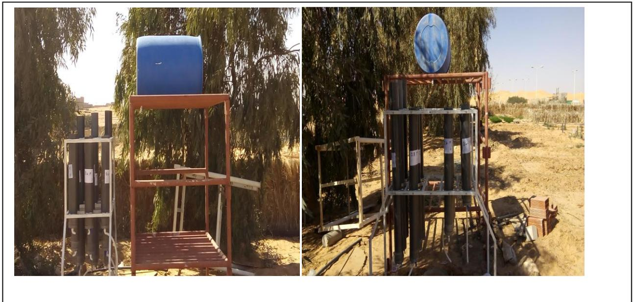
**Photos N° 01** : Installation pilote du système des filtrations lente sur sable
