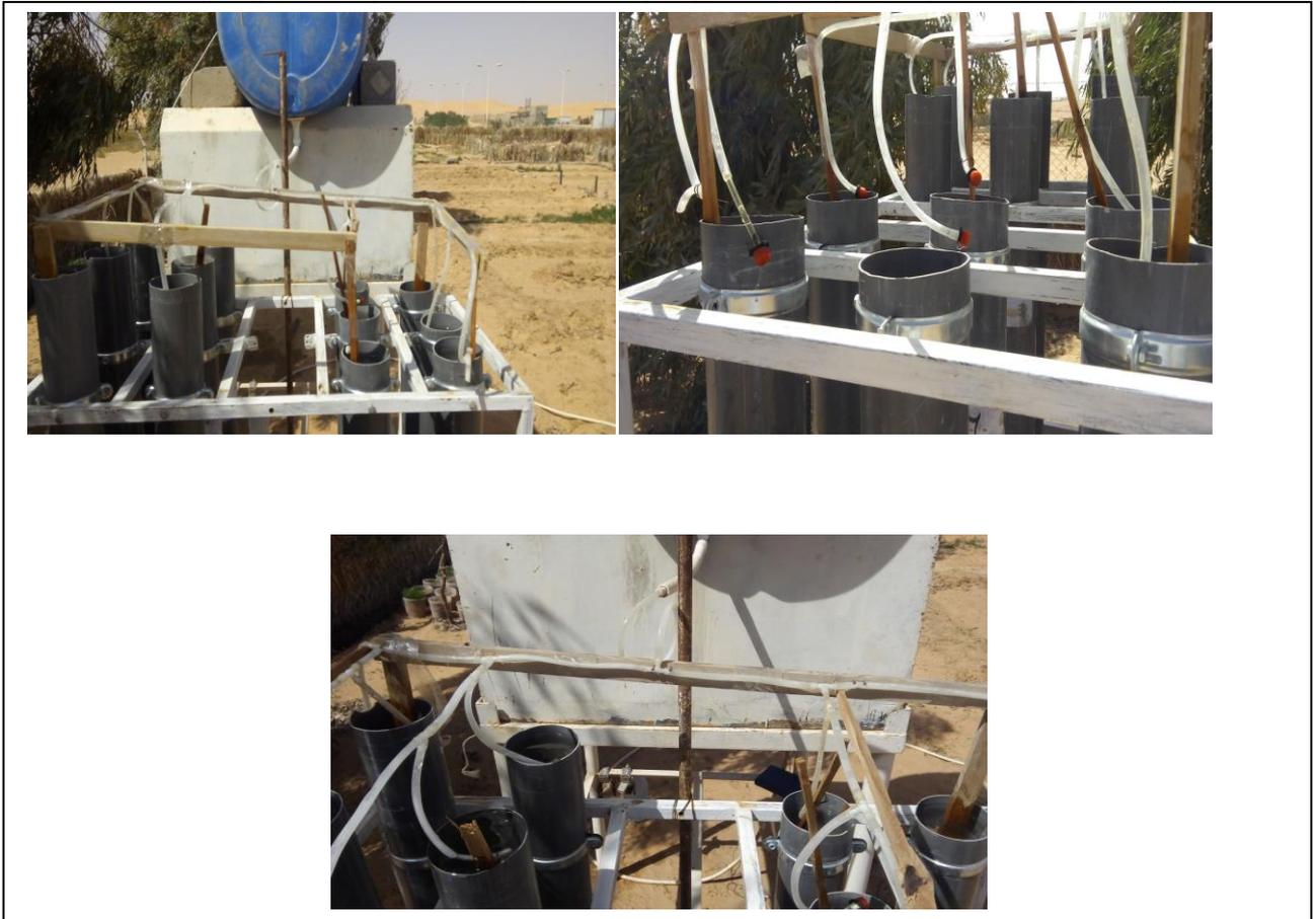
**Photos N° 02 :** Distribution d'eau sur les filtres avec des régulateurs débité
