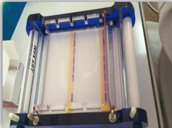
**Figure 24: Cuve d'électrophorèse contenant nos échantillons (Cds).**
