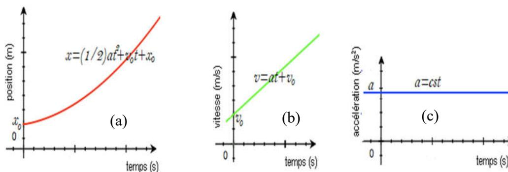
Fig.19 diagrammes (a) la position, (b) de la vitesse et (c) de l'accélération
