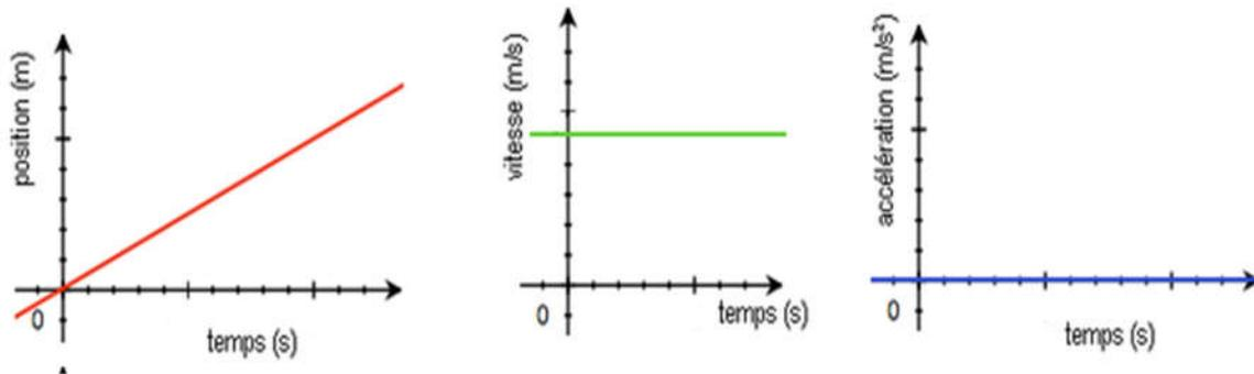
Fig. 18 : diagrammes (a) de la position, (b) de la vitesse et (c) de l'accélération
