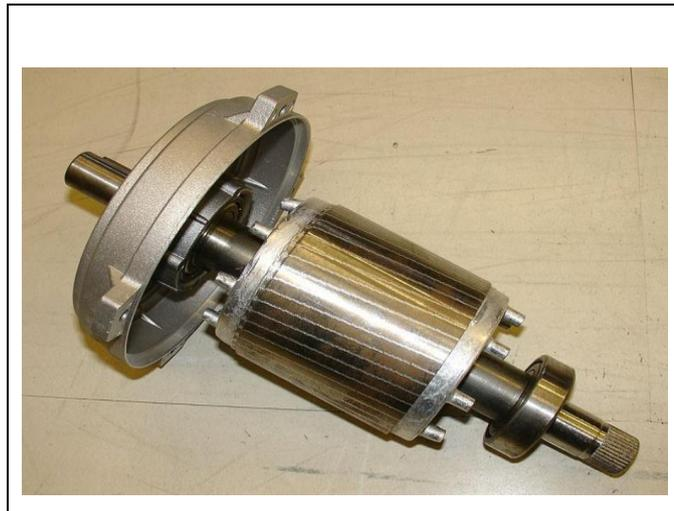
**Fig.II-5.** Rotor à cage.
