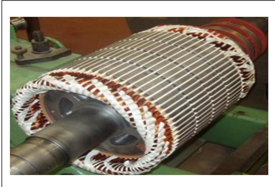
**Fig.II-4.** Rotor bobiné.
