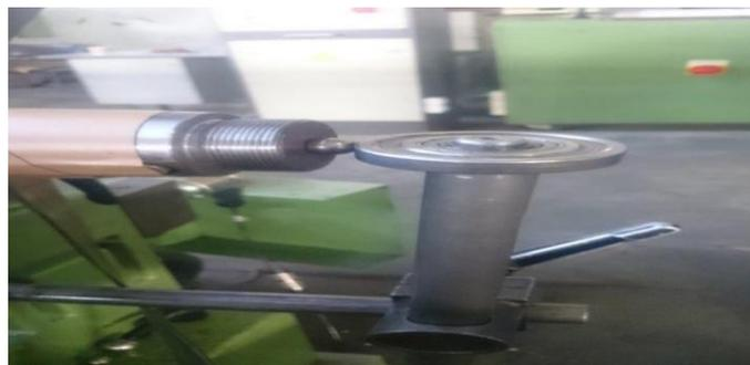
**Fig.III-26.** Fixation de roulement de buté axiale sur le rotor.
