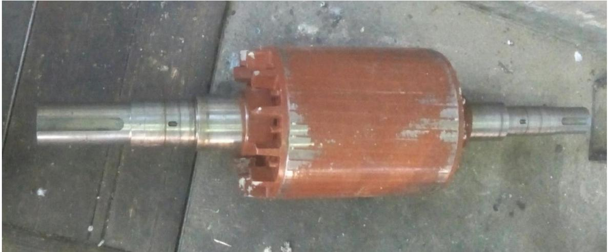
**Fig.III-19.** Rotor d'un moteur asynchrone.
