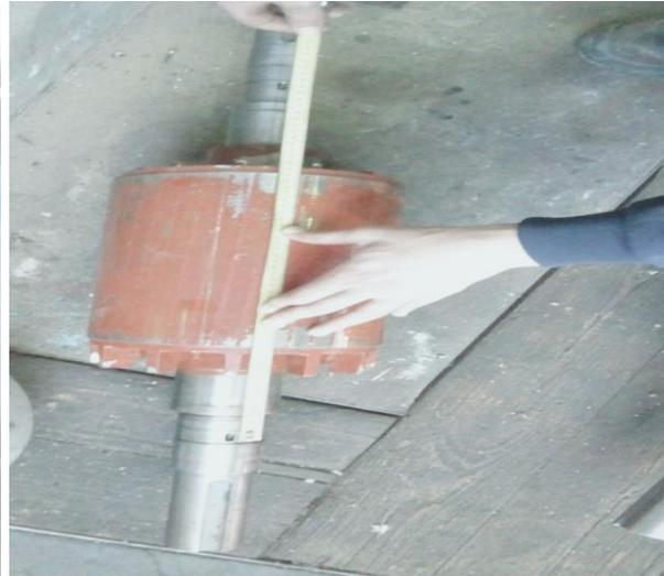
**Fig.III-22.** Mesurer le long de rotor.
