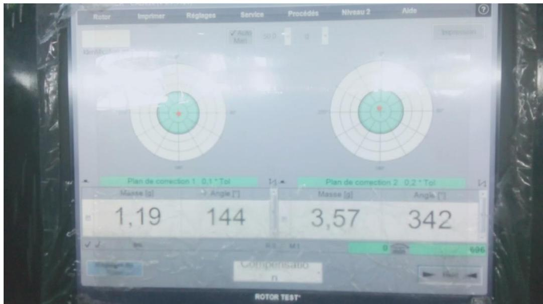
Fig.III-32. Le rotor en tolérance.
