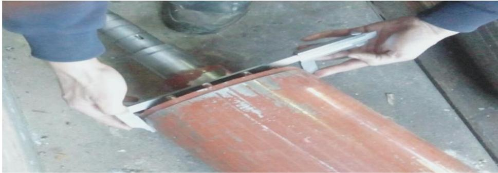
**Fig.III-23** Mesurer le diamètre de rotor.
