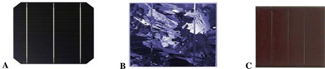
Figure II.4:Photos d'une cellule : (A) monocristalline, (B) poly cristallin,(C) amorphe.
