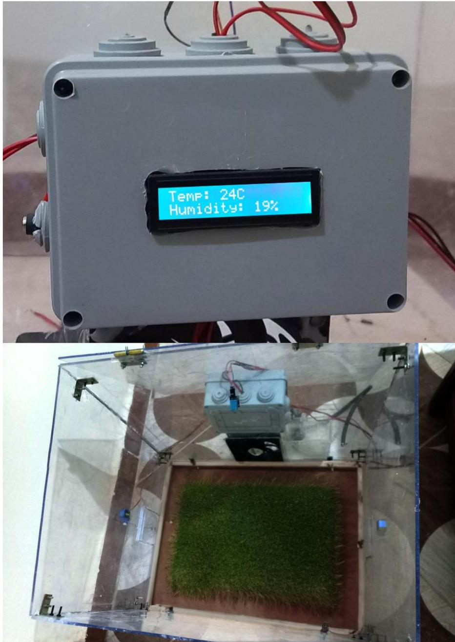
**Figure IV-7 :** Maquette d'une serre agriculture réaliser
