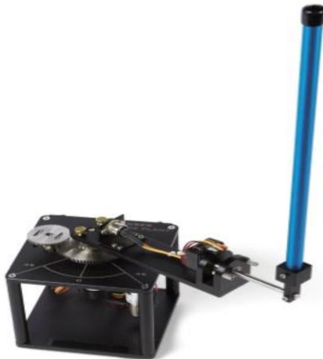
**Figure II.1.** Système Pendule inversé rotatif
