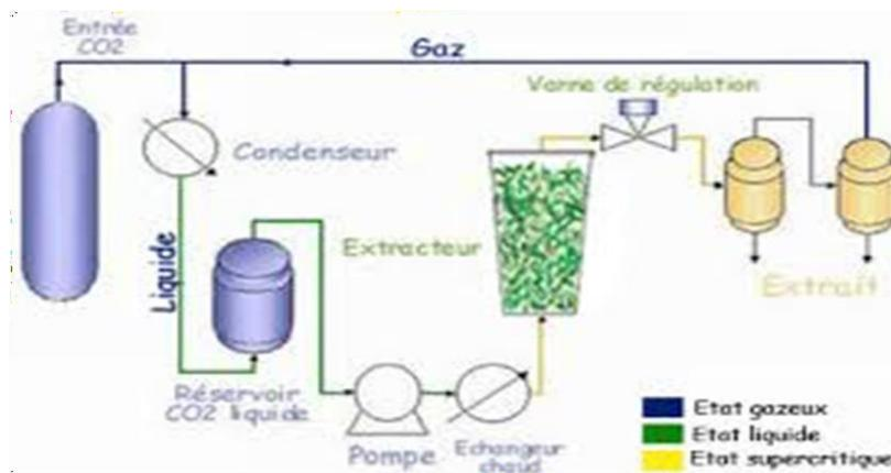
Figure 20: Technique d'extraction par CO<sub>2</sub> supercritique
