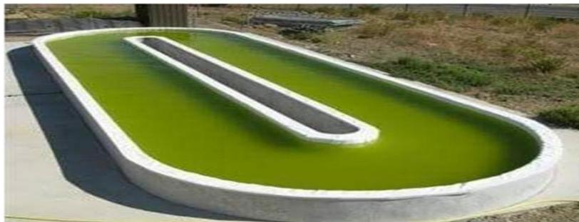
Figure 11: Production de micro algues dans le raceway
