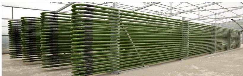
Figure 11: Photo bioréacteurs type tubulaires
