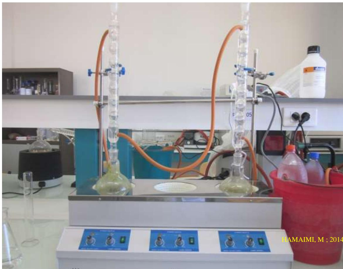
**Photo2** – Dispositif d'extraction des principes actifs par reflux.
