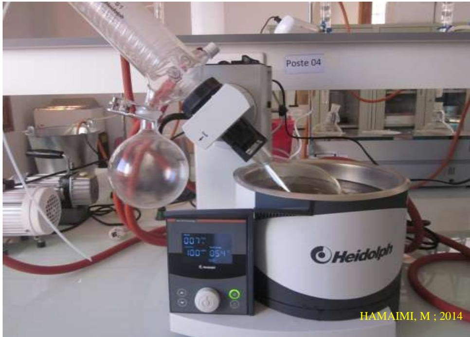
**Photo 3:** Elimination d'éthanol par évaporateur.
