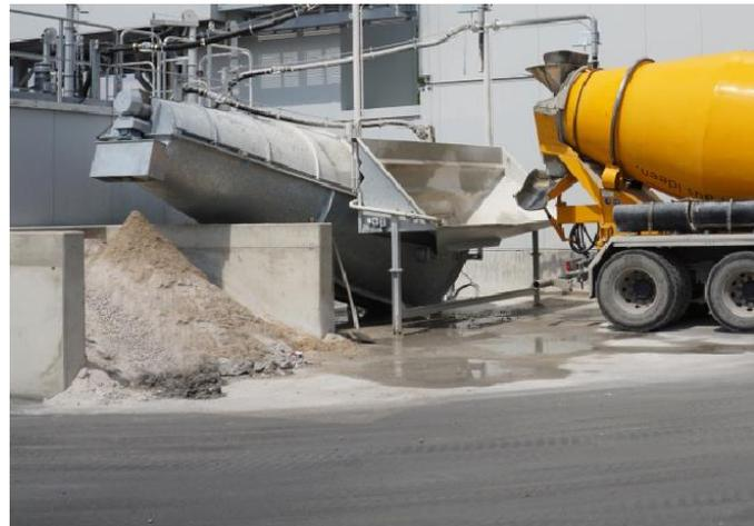
**Figure 1.3 Installation de recyclage de l'eau avec une cuve de relevage**
