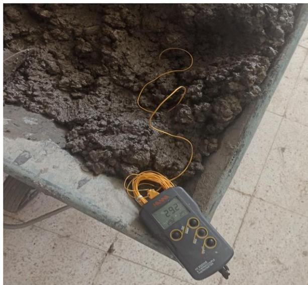
**Photo 2.6** Mesure de la température du béton
