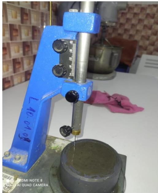
**Photo 2.4** Mesure de prise du ciment
