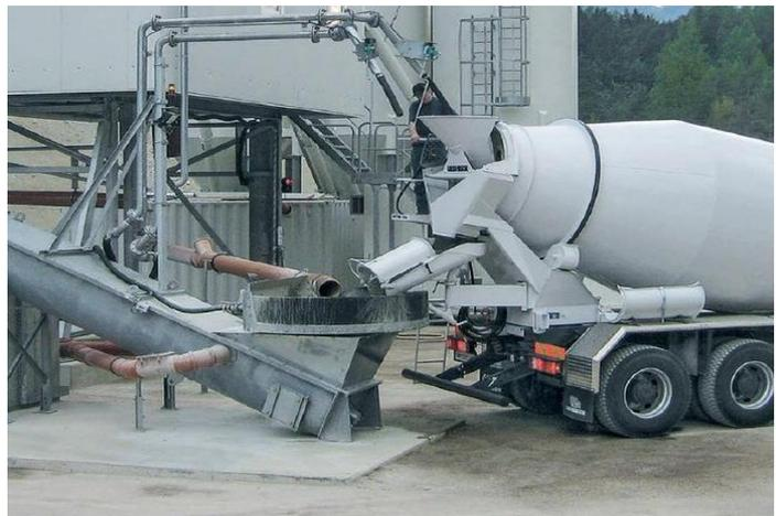
**Figure 1.2** Installation de recyclage de l'eau avec une vis de relevage
