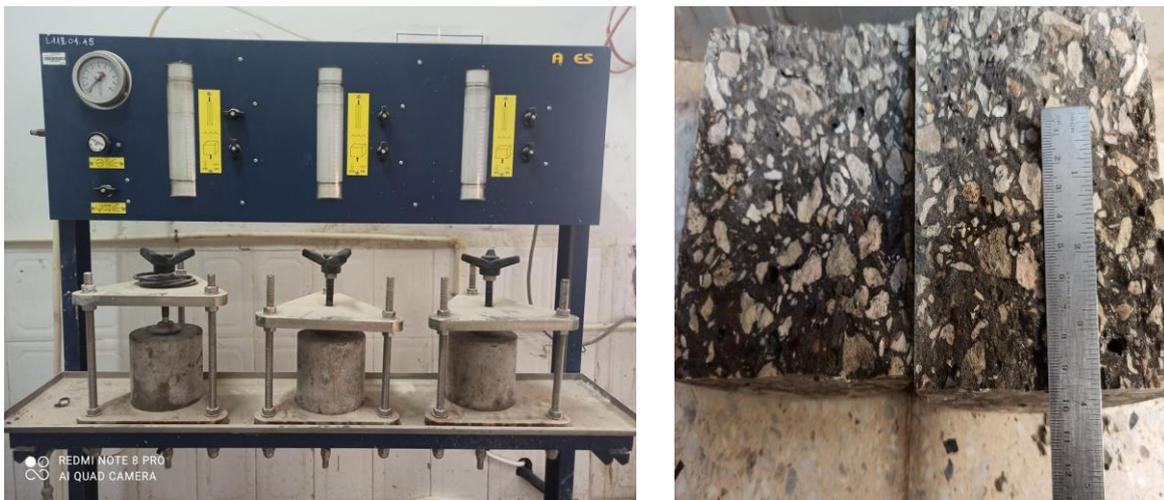
**Photo 2.10** Mesure de la perméabilité du béton
