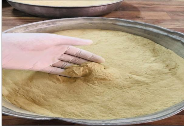
Figure III.7 - la bentonite après un broyage mécanique.
