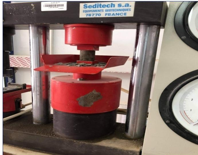
Figure III.14 - Dispositif de résistance à la compression.
