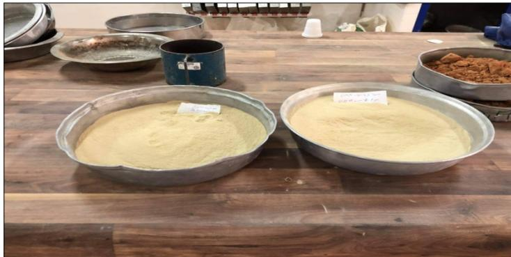
Figure III.2 - Bentonite après le séchage.
