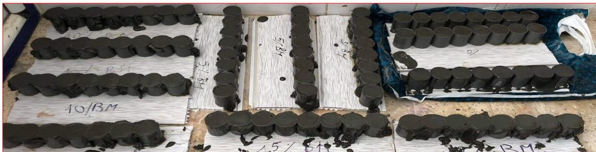
Figure - 12 : Eprouvettes pate de ciment.
