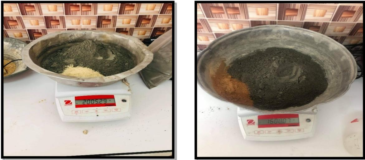
Figure III.11 - Ciment avec le substitut de la bentonite.
