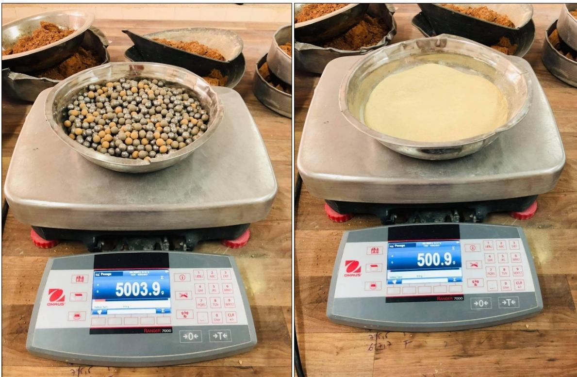
Figure III.4 - la bentonite et les boulets sphériques.
