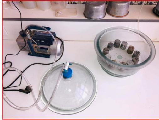
Figure III.16 - Dispositif de mesure de la porosité accessible à l'eau.
