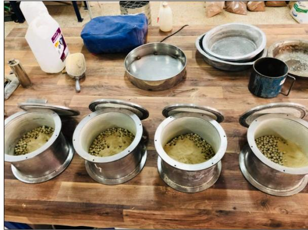
Figure III.5 - les boulets à mélanger avec la bentonite dans les cylindres creux.
