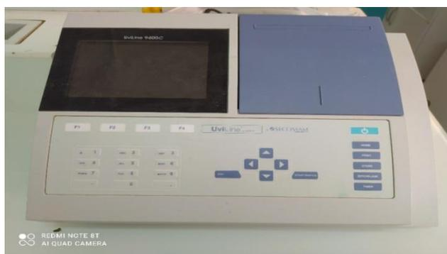
**Figure 21 : Spectrophotomètre UV visible de type Thermo Fisher Scientific (Uviline9400C)**
