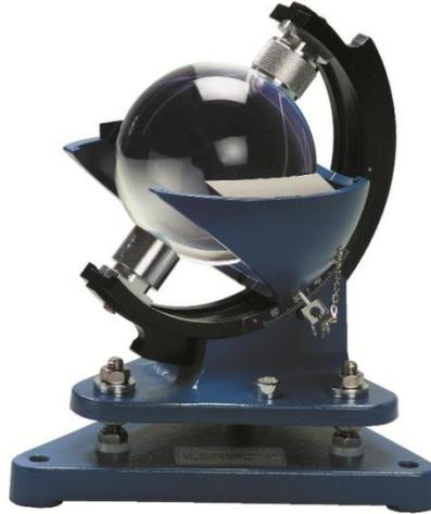
Figure I.19 : héliographe (durée d'insolation).
