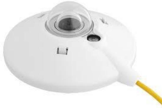
Figure I.18: Pyranomètre (direct+diffus+albédo).
