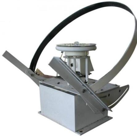
Figure I.16 : le Pyranomètre (diffus).
