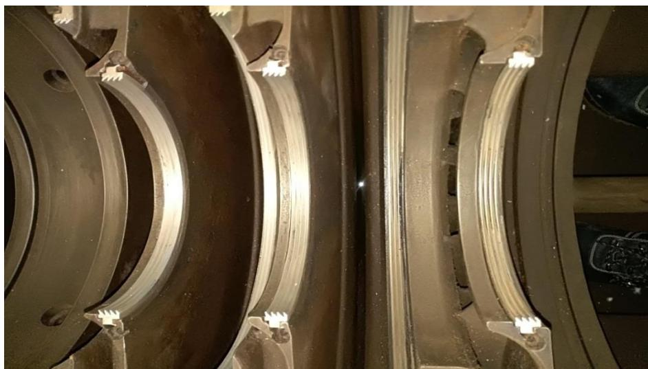
Figure : III.21 : Labyrinthe enter étage
