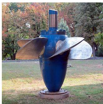
Figure II.8 : Turbine hydraulique
