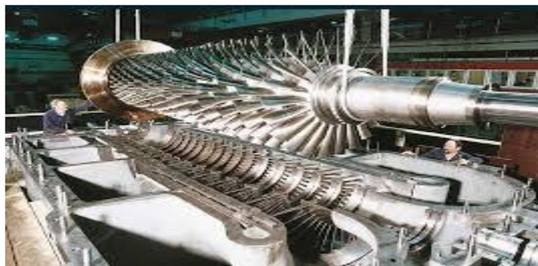
Figure II.22 : Compresseur dynamique axial
