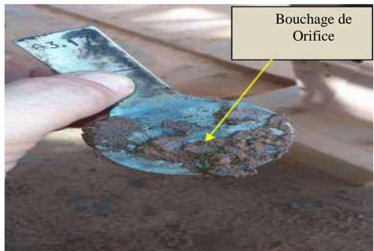
Figure V.11.b: Bouchage des orifices au niveau picages qui liée avec la ligne de refroidissement la pompe d'expédition du brut.
