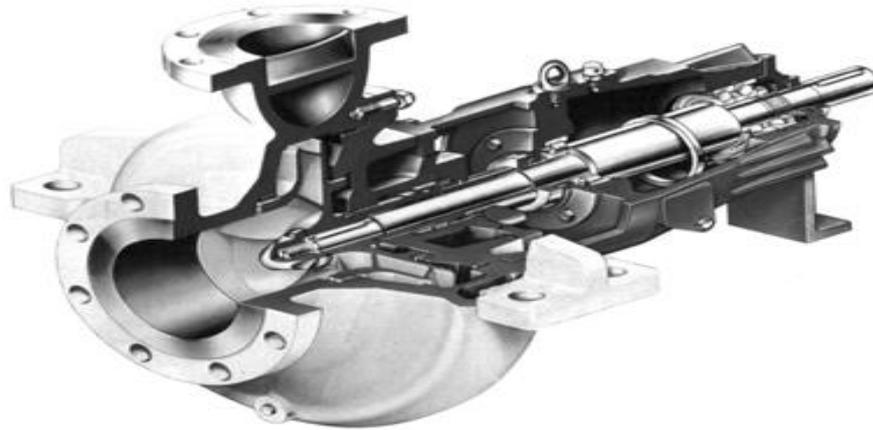
Figure II.11 : Pompe centrifuge
