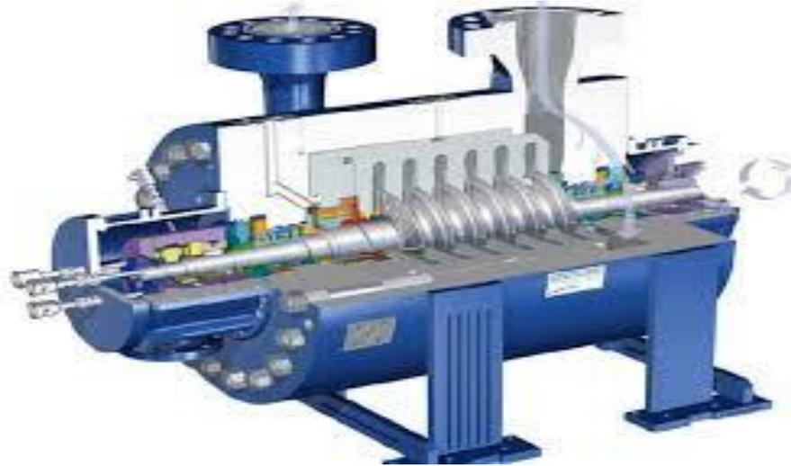
Figure II.23 : Compresseur centrifuge
