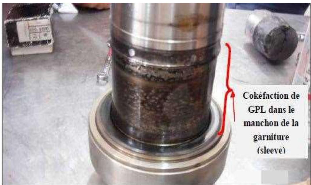
Figure V.8: Dépôts noirs sur le manchon de la garniture
