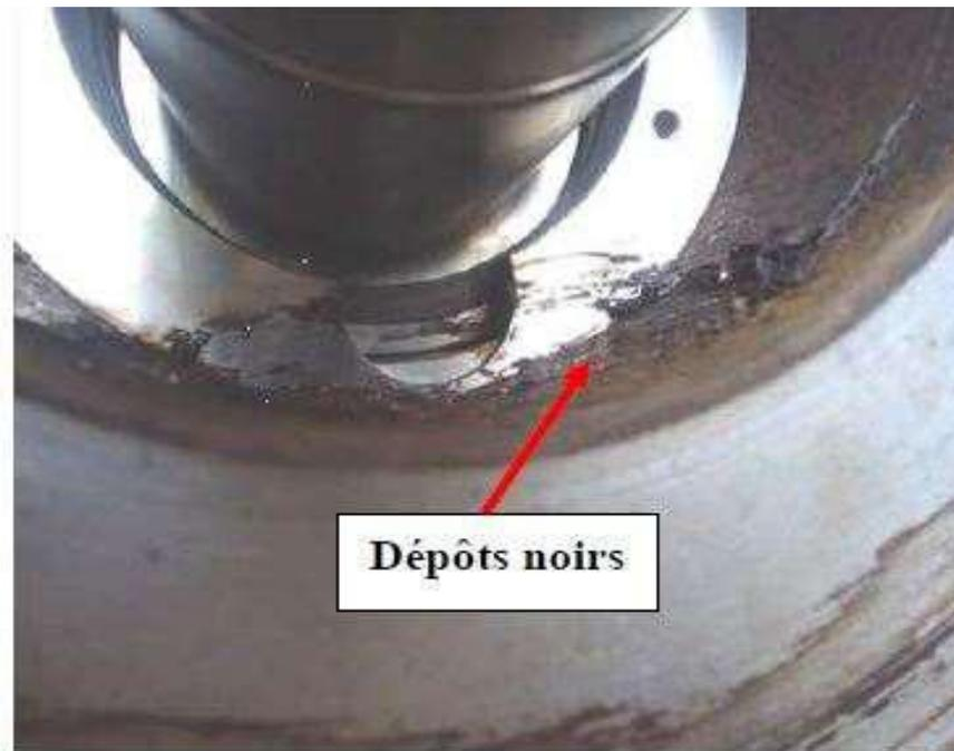
Figure V.7: Dépôts noirs dans le logement de garniture de la pompe d'expédition de GPL
