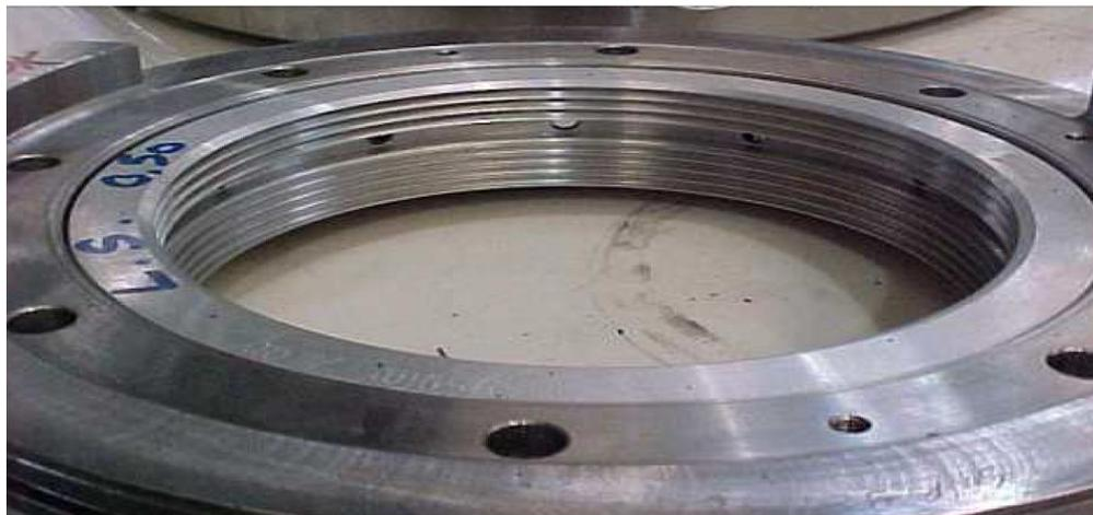
Figure III.22 : Joint à labyrinthe [44]
