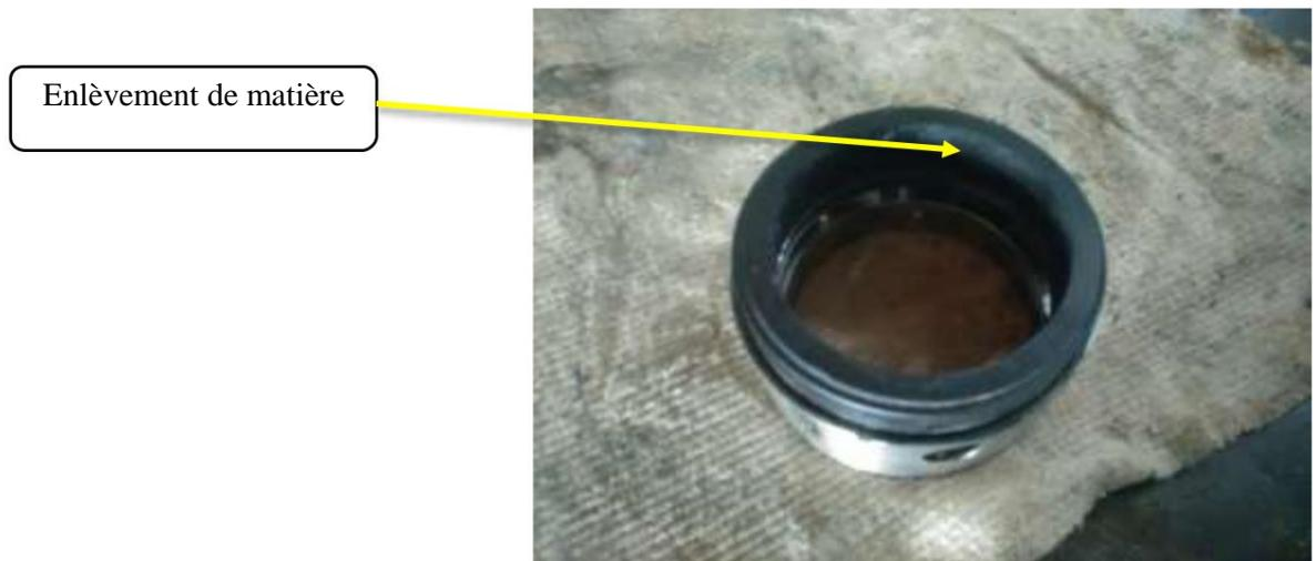
Figure V.14.a: Grain mobile de la pompe reflux condensat 40-P-06 A
